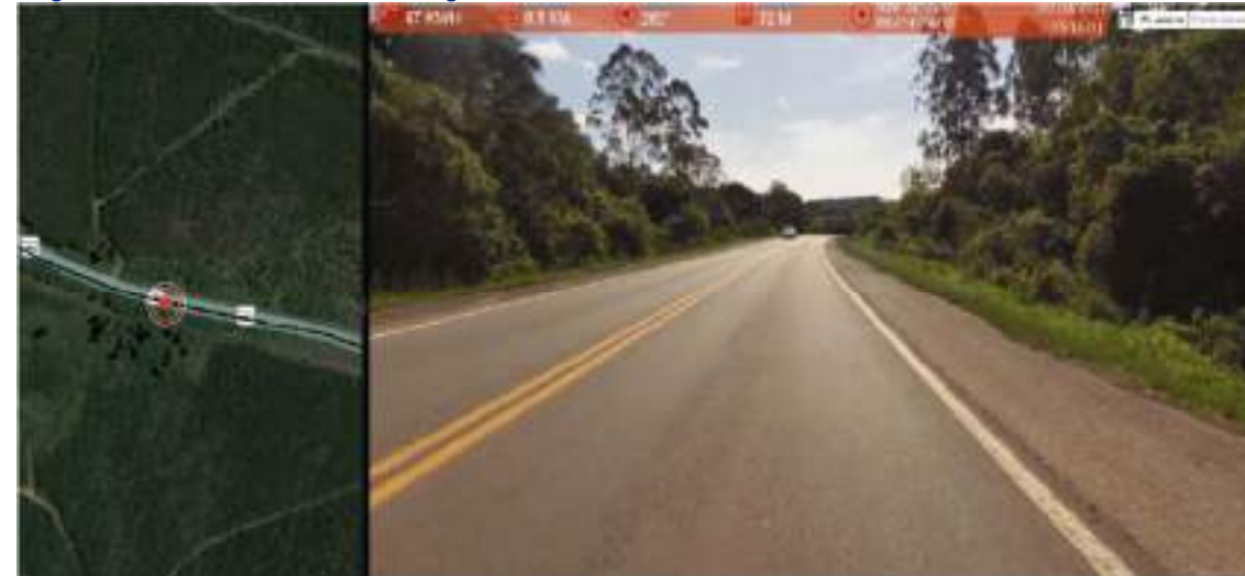
Figura 5 - Acostamento com Largura Inferior a 2,00 m.
