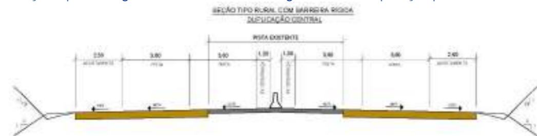
Figura 8 - Seção Tipo 3 - Região Rural com Barreiras Rígidas com a Duplicação pelo Eixo Central.
