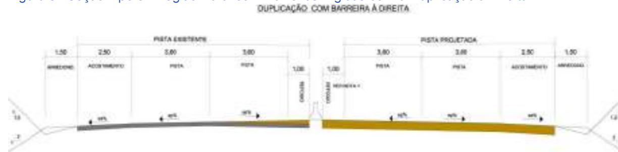
Figura 9 - Seção Tipo 3 - Região Rural com Barreiras Rígidas com a Duplicação à Direita.
