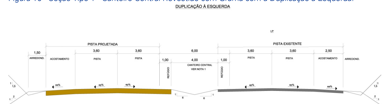
Figura 10 - Seção Tipo 1 - Canteiro Central Revestido com Grama com a Duplicação à Esquerda.
