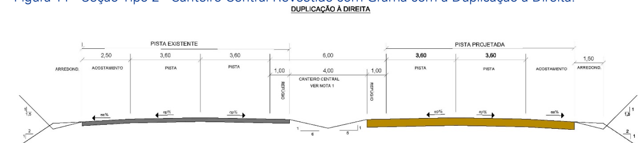
Figura 11 - Seção Tipo 2 - Canteiro Central Revestido com Grama com a Duplicação à Direita.
